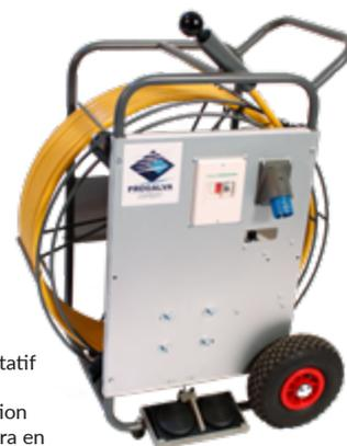
Le Rotobrosse 22 est un matériel de brossage rotatif équipé d'un câble de 22 m pouvant entraîner des brosses de Ø 200 à Ø 600 mm. La conception du câble avec embout démontable vous permettra en cas de casse, un dépannage immédiat sur votre chantier. L'ensemble est monté sur un dévidoir, équipé de 2 roues gonflables permettant la montée et descente des escaliers.
